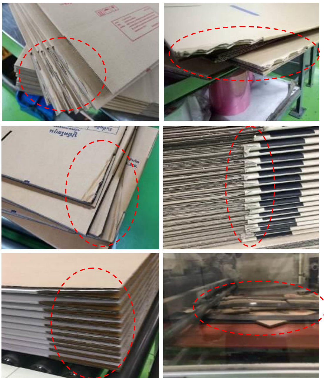
รูปที่ 3.30 ความเสียหายของชิ้นงานจากปัญหากระดาษติดที่ชุดรางพับ
