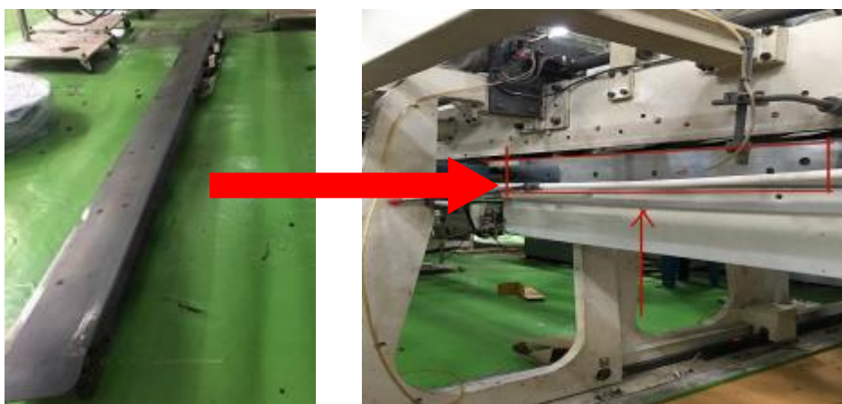
รูปที่ 4.7 การตรวจเช็คและเปลี่ยนขอบรางพับ
