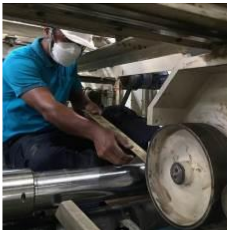
รูปที่ 4.5 ทำการตรวจเช็คและเปลี่ยนยางหุ้มพูเลย์ใหม่
