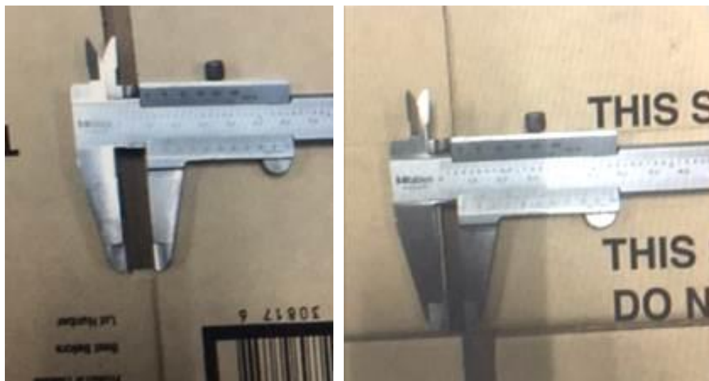
รูปที่ 4.1 ร่องกาวของกระดาษเกิดการขีดห่างไม่อยู่ในค่าที่กำหนด
