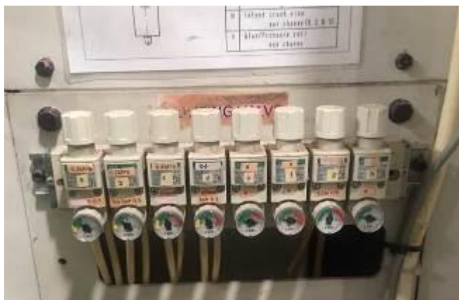
รูปที่ 4.8 การตรวจเช็คครบกลมและจัดทำการควบคุมด้วยการมองเห็น (visual control) ที่เกจวัดความดัน
