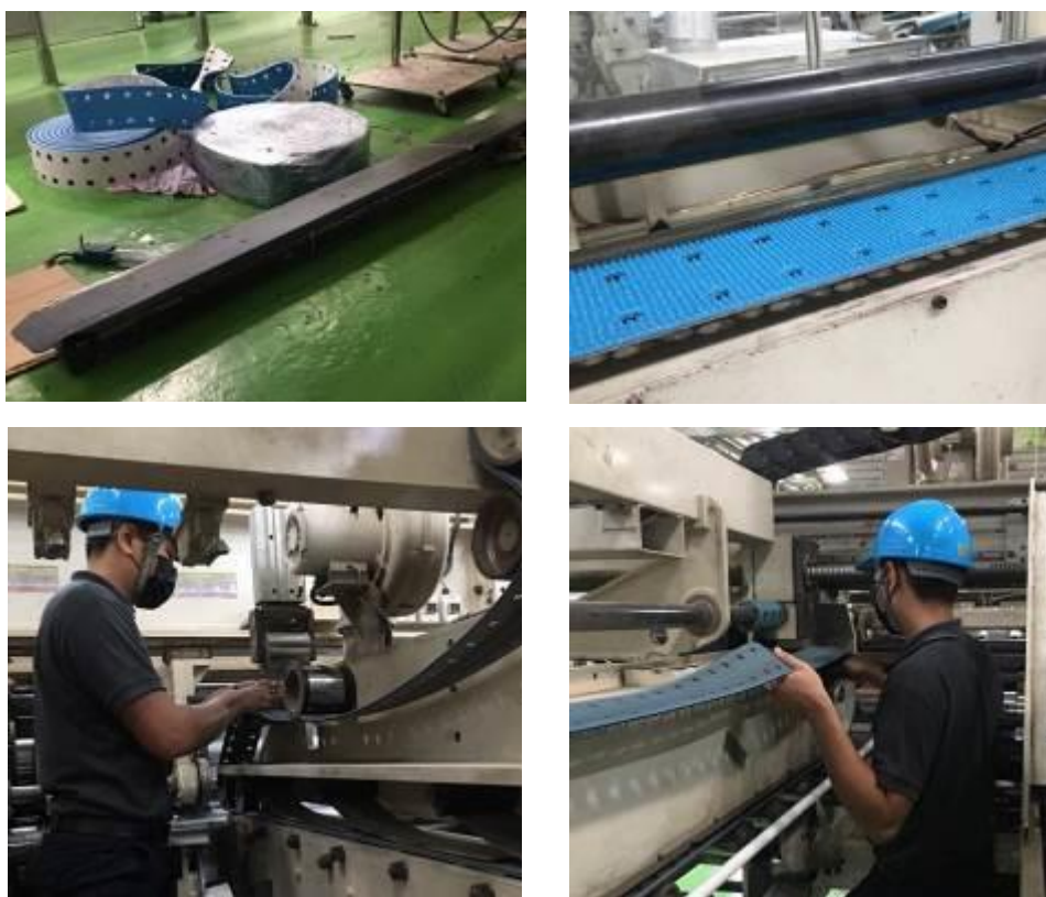
รูปที่ 4.3 การเปลี่ยนสายพานบน สายพานล่างเข้า และสายพานล่างออก
