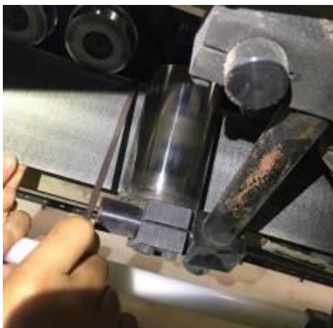
รูปที่ 4.4 ทำการตรวจเช็คระยะ และปรับตั้งเกจโรล
