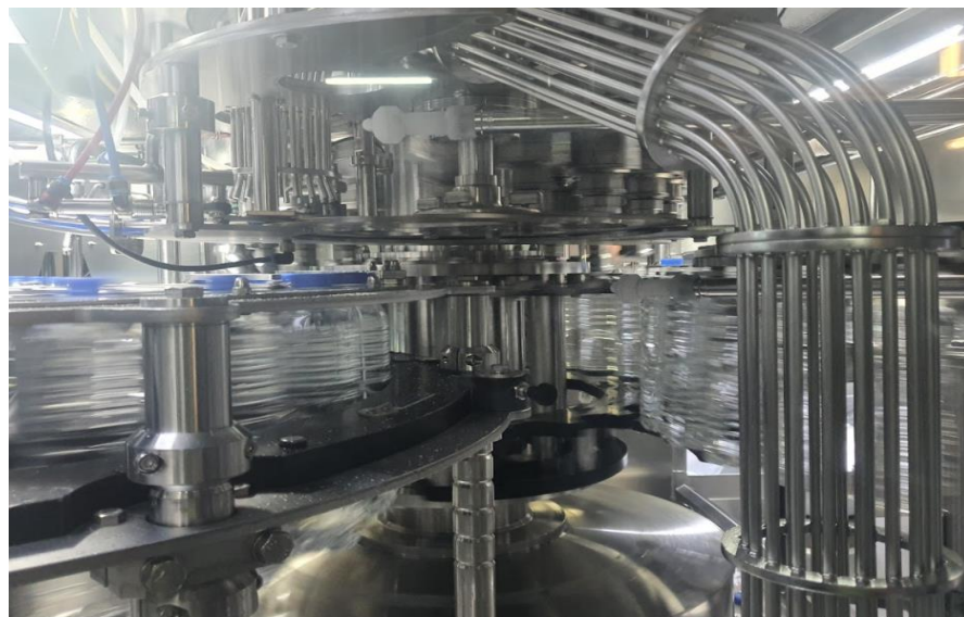
รูปที่ 4.7 ขั้นตอนการปิดฝาดด้วยเครื่องปิดฝาด
