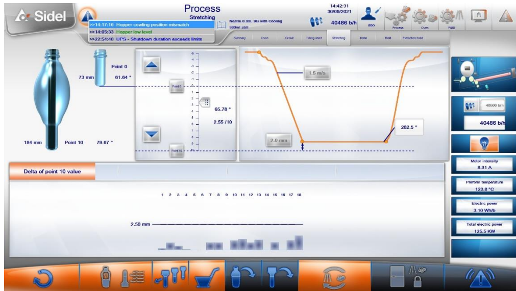
รูปที่ 4.3 ขั้นตอนการเป่าขวดควบคุมผ่าน HMI เครื่องเป่าขวด
