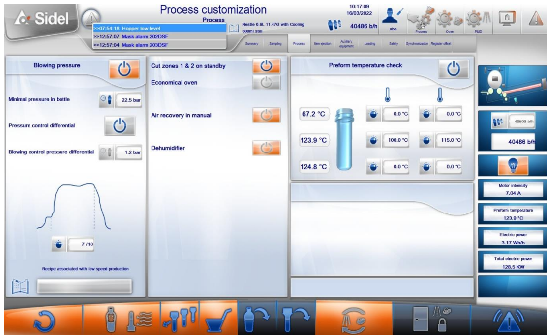
รูปที่ 4.38 มาตรฐานการปรับตั้งค่าการรีเจ็คขวดร้วหลังการเป่าที่เครื่องเป่าขวด
