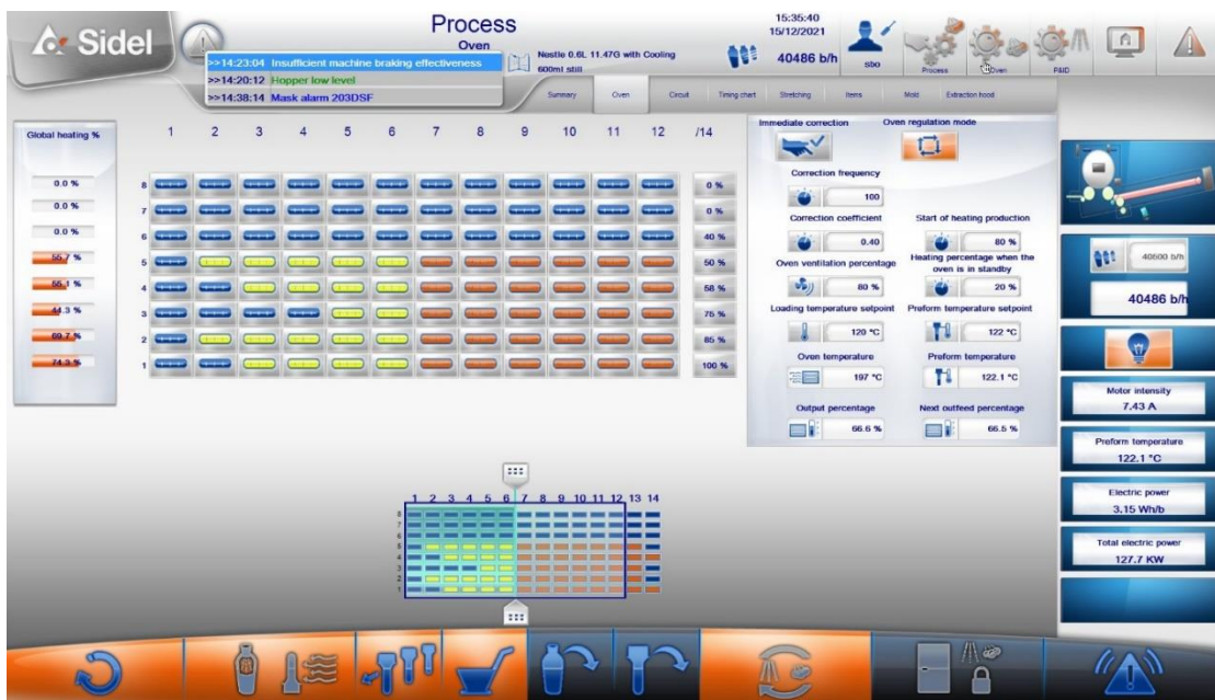
รูปที่ 4.27 มาตรฐานการปรับตั้งอุณหภูมิพรีฟอร์ม
