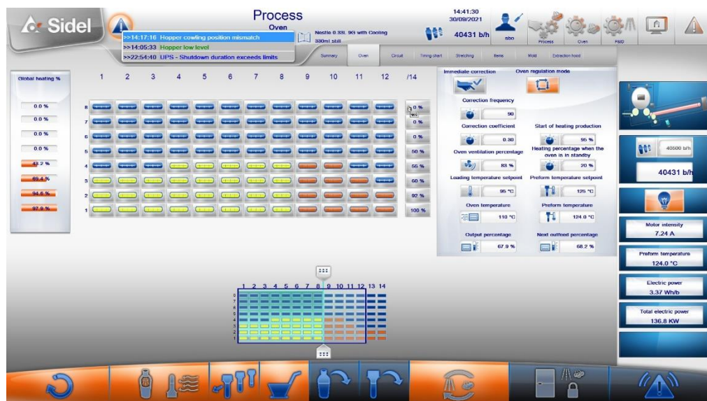
รูปที่ 4.2 การควบคุมอุณหภูมิพรีฟอร์มผ่าน HMI ของเครื่องเป่าขวด
