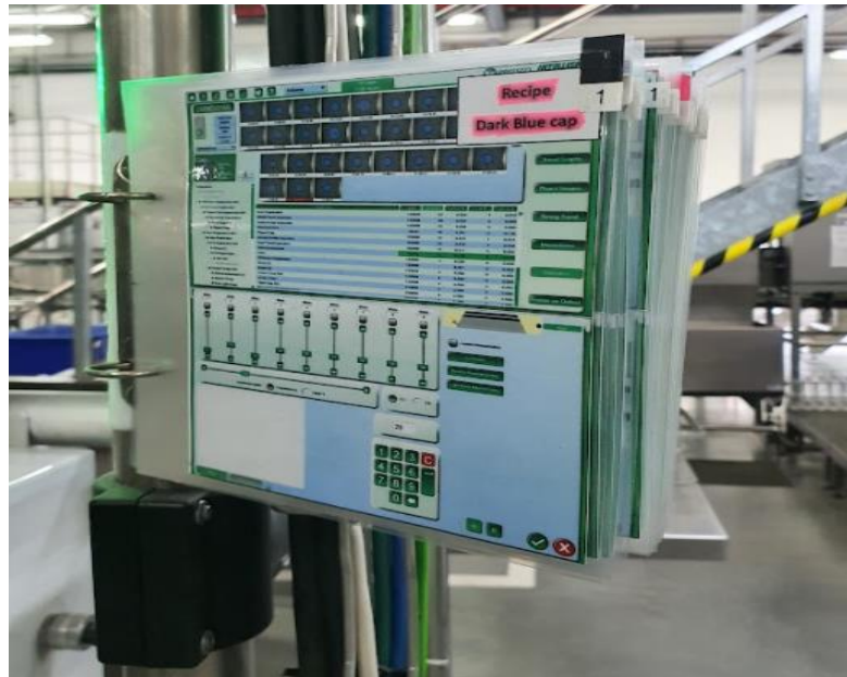
รูปที่ 4.35 มาตรฐานพารามิเตอร์สำหรับเครื่องตรวจฝา (Cap Inspector)
