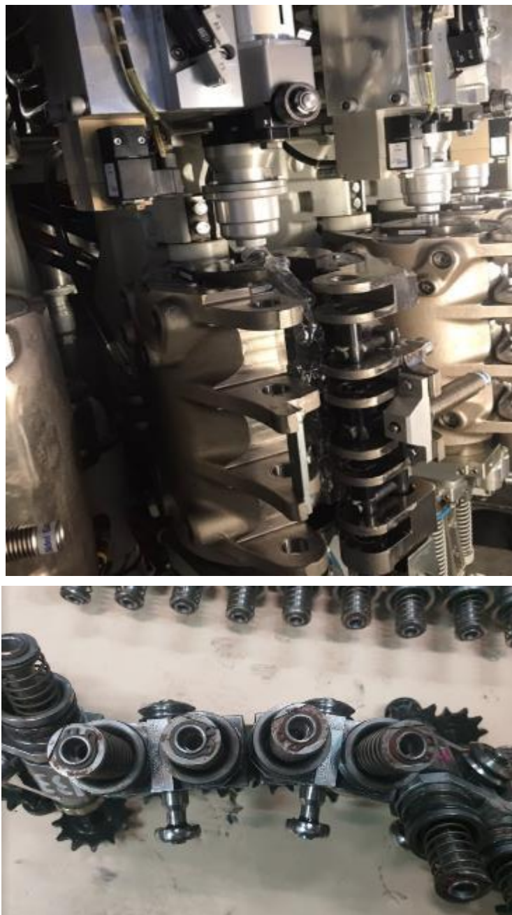
รูปที่ 4.14 ปัญหาการหยุดกระทันหันของเครื่องเป่าขวดและสาเหตุที่ทำให้เกิด
