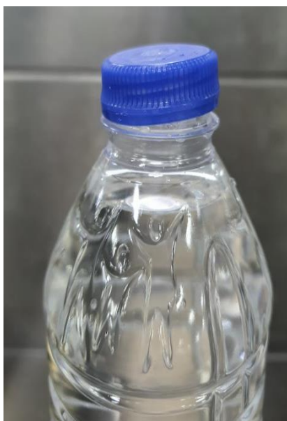
รูปที่ 4.26 ตัวอย่างของเสียประเภทปิดฝาไม่สนิทและหลักการทำงานของเครื่องตรวจสอบขวด
