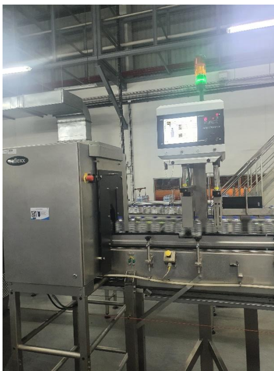
รูปที่ 4.8 ขั้นตอนการตรวจสอบระดับน้ำและการปิดฝา
