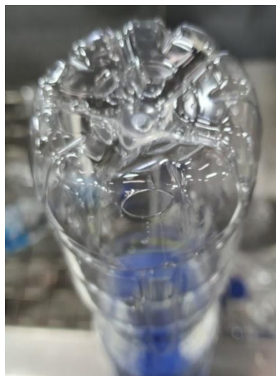
รูปที่ 4.24 การทำงานของเครื่องตรวจสอบระดับน้ำและตัวอย่างขวดร้าวที่ผ่านเข้ามาบรรจุน้ำและปิดฝา
