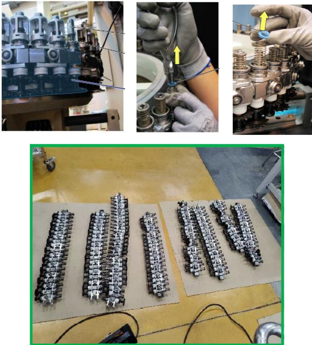
รูปที่ 4.28 ทำการเปลี่ยนชุดสปินเดิล (Spindle)
