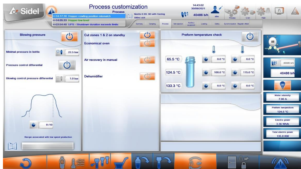
รูปที่ 4. 4 ขั้นตอนการตรวจเช็คขวดรั่วระหว่างการเป่าขวด
