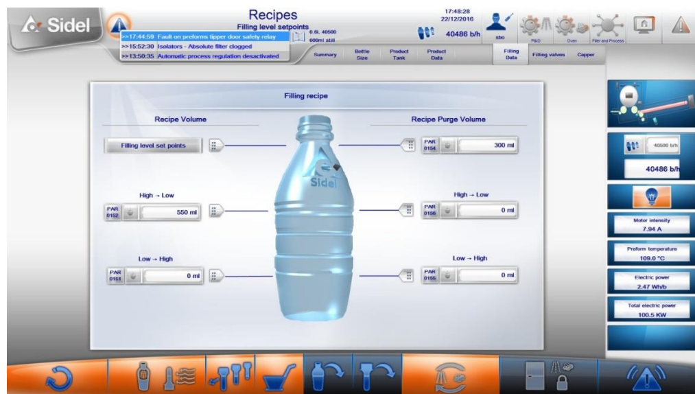
รูปที่ 4.5 การควบคุมการบรรจุน้ำผ่าน HMI เครื่องบรรจุน้ำ
