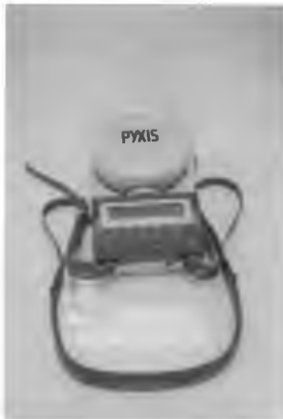
ภาพประกอบ 31 เครื่องมือวัดพิกัดจุดเก็บตัวอย่าง (Global position system)
