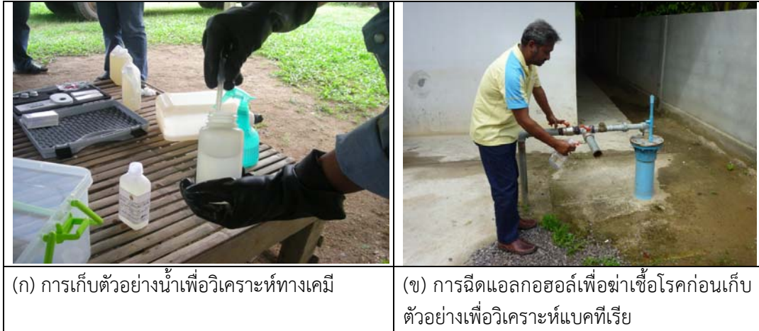
รูปที่ 3-1 แสดงขั้นตอนการเก็บน้ำตัวอย่างเพื่อวิเคราะห์คุณสมบัติทางเคมีและวิเคราะห์แบคทีเรีย
