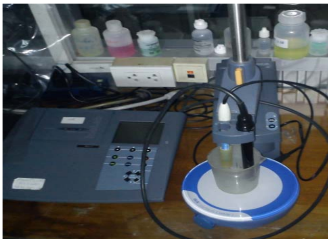
รูปที่ 3-3 เครื่องมือวิเคราะห์ความเป็นกรด-ด่าง (pH) และ การนำไฟฟ้า
