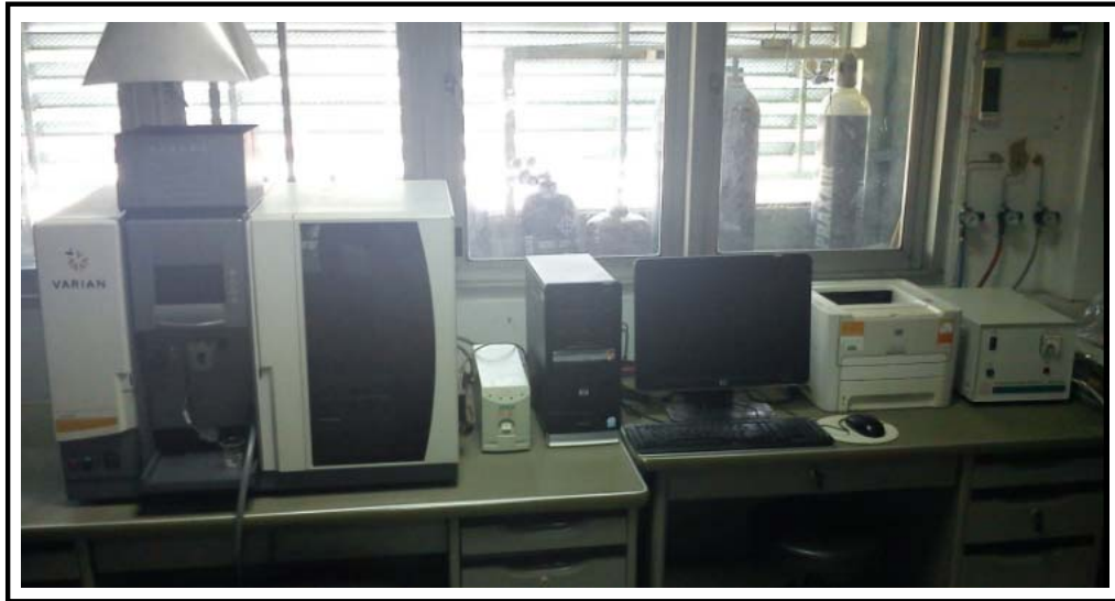
รูปที่ 3-4 เครื่องมือวิเคราะห์เหล็ก แมงกานีส ทองแดง และสังกะสี
