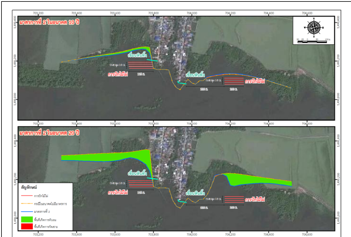
(ข) มาตรการที่ 2 : รื้อถอน Jetty และทำการปักไม้ไผ่เป็นแนว ทั้งสองด้านของปากคลองหงษ์ทองแทน
