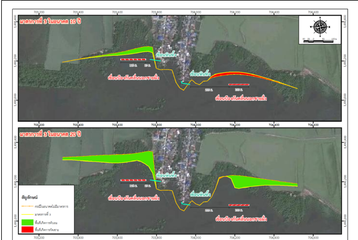
(ค) มาตรการที่ 3 : รื้อถอน Jetty และทำการสร้างเขื่อนป้องกันคลื่นนอกชายฝั่งแทน
