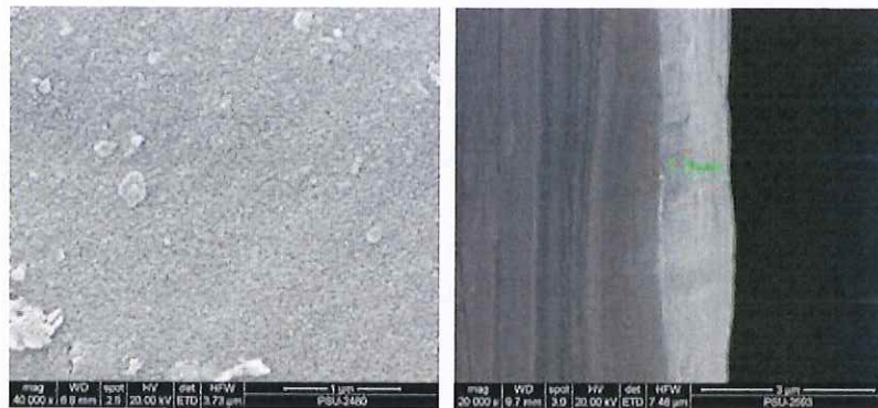
รูปที่ 4.17 ภาพถ่าย SEM ของพื้นผิวของฟิล์มและความหนาของฟิล์มของไทเทเนียมไดออกไซด์ ได้ปไนโตรเจน
