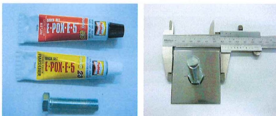
รูปที่ 4.38 กาวอีพอกซีและชิ้นงานที่ใช้ในการทดสอบความแข็งแรงของฟิล์มด้วยวิธีการดึง
