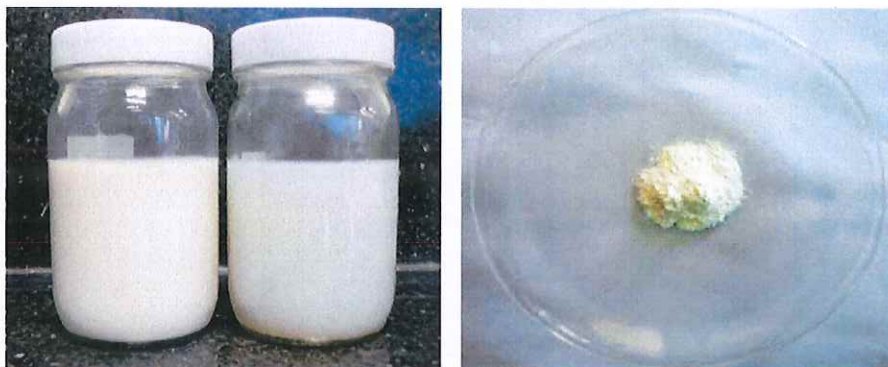
รูปที่ 4.3 โซลของไทเทเนียมไดออกไซด์และผงที่เผาที่อุณหภูมิ 100 องศาเซลเซียส
