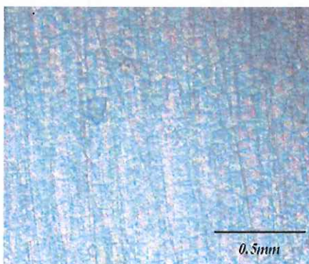
รูปที่ 4.12 ภาพถ่ายพื้นผิวของฟิล์มไทเทเนียมไดออกไซด์ที่จำนวนชั้นเคลือบ 5 ชั้น
