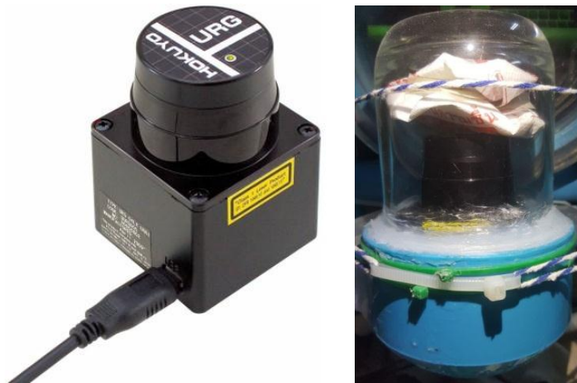
รูปที่ 2.20 เซนเซอร์ HOKUYO URG-04LX-UG01 ก่อนดัดแปลง (ซ้าย) และหลังดัดแปลง (ขวา)
