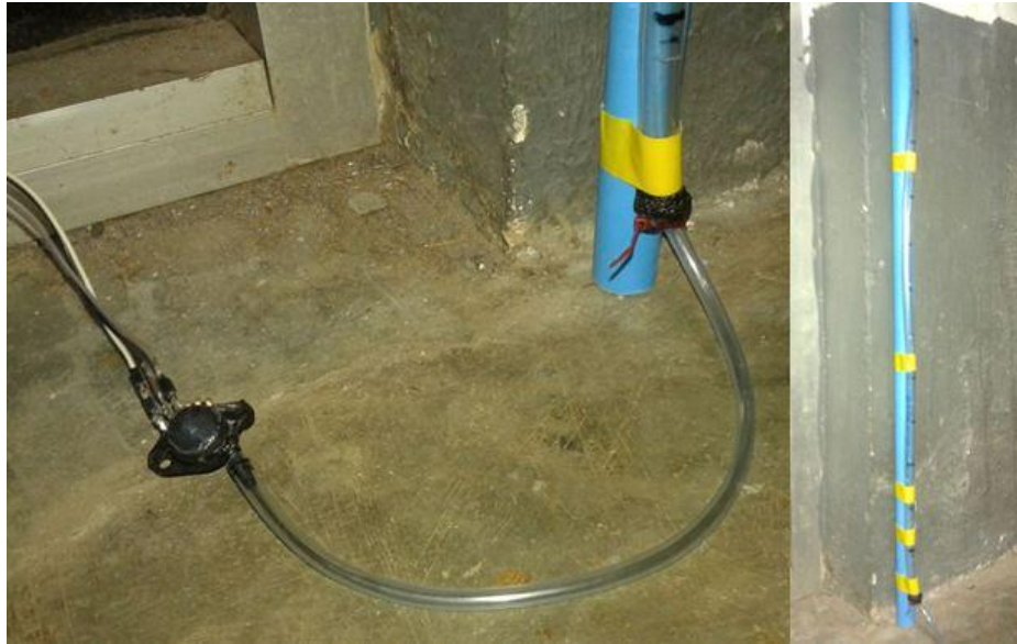
รูปที่ 2.16 การทดสอบปรับเทียบเซนเซอร์วัดความดัน
