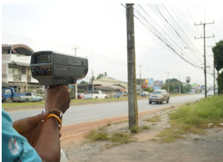
รูปที่ 4-3 การสำรวจความเร็วด้วยปืนเรดาร์
