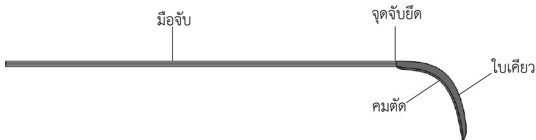
รูปที่ 2.2 ส่วนประกอบของเคียวตัดปาล์มน้ำมัน
