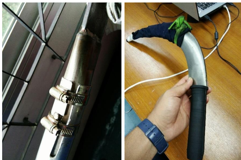
รูปที่ 4.21 รูปแบบการยึดใบบนเคียวโดยการเชื่อม (ซ้าย) และโดยการใช้ตัวล๊อค (ขวา)
