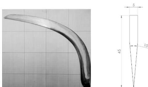
รูปที่ 4.7 ลักษณะใบเคียว และ ขนาดหน้าตัดคมเคียวส่วนกลาง
