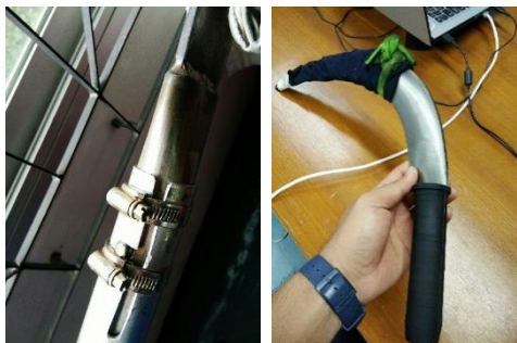
รูปที่ 4.39 รูปแบบการยึดใบเคียว โดยการเชื่อม (ซ้าย) และโดยการใช้ตัวล็อค (ขวา)
