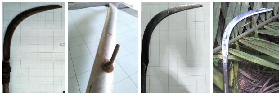
รูปที่ 2.4 การยึดใบเคียวกับด้ามจับ โดยวิธีการรัดด้วยยาง ใช้สกรูยึด ใช้การเชื่อม และการใช้แคลมป์รัด ตามลำดับ
