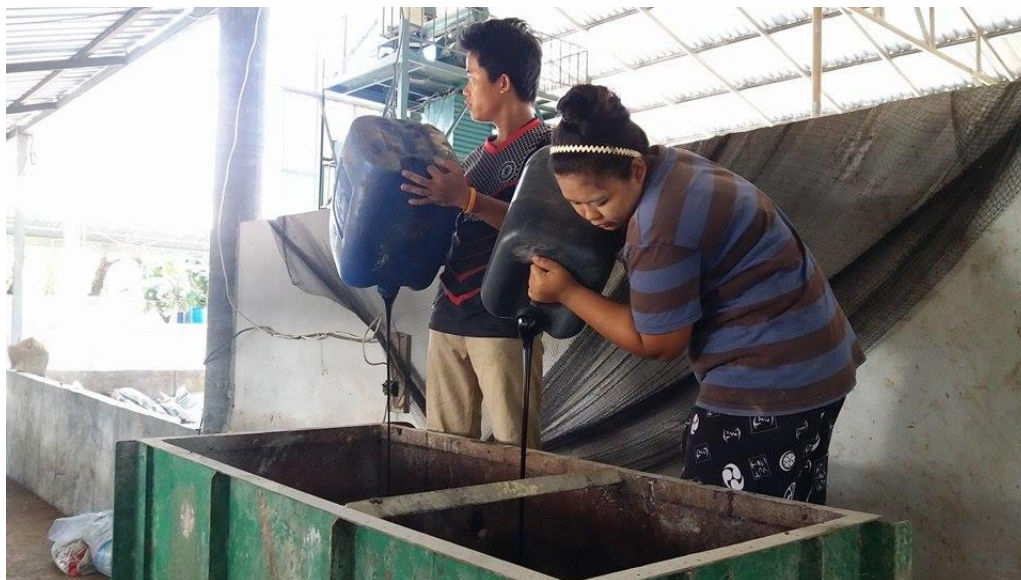
ภาพที่ 5 ลักษณะการผสมวัตถุดิบลงในเครื่องผสมอาหารแบบแนวนอน
