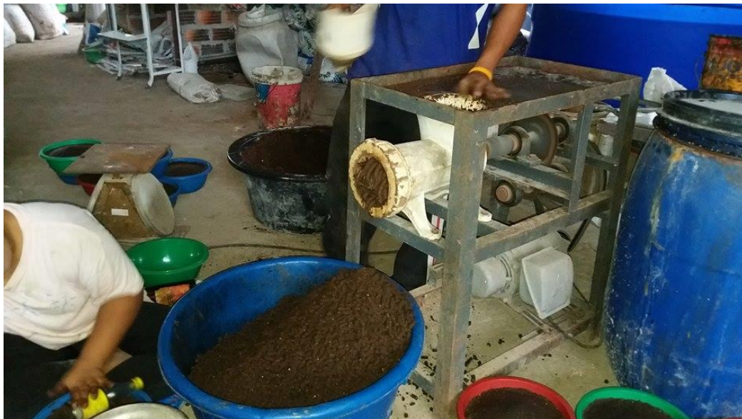
ภาพที่ 8 ลักษณะการนำอาหารผ่านเครื่องอัดละเอียดเพื่อให้ง่ายต่อการขึ้นรูปก้อน ที่มา : เอกอนงค์ สิทธิประการ ถ่ายเมื่อวันที่ 25 มกราคม 2560
