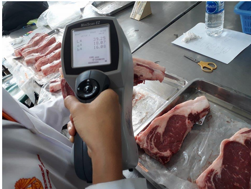
ภาพที่ 22 ภาพแสดงเครื่องวิเคราะห์สีของเนื้อ ที่มา : เอกอนงค์ สิทธิประการ ถ่ายเมื่อวันที่ 24 เมษายน 2561
