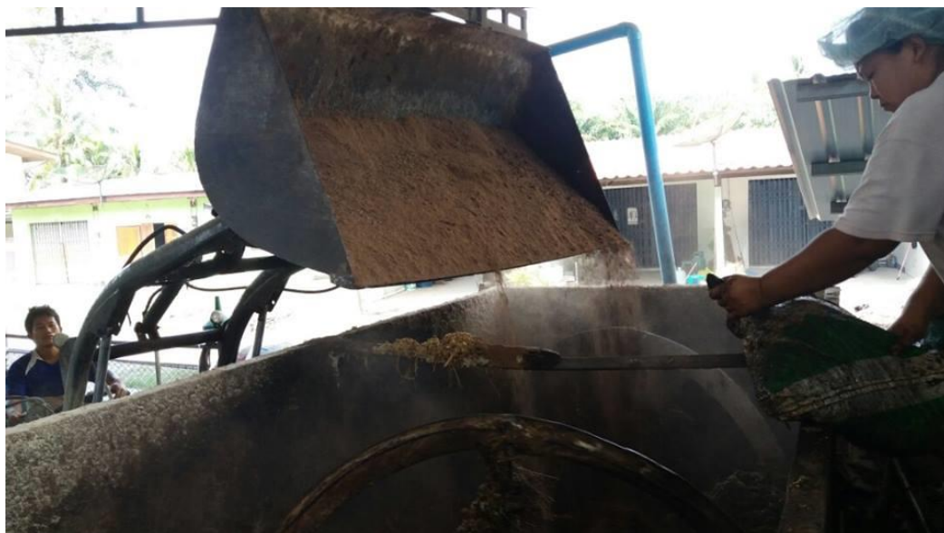
ภาพที่ 13 ลักษณะการผสมวัตถุดิบลงในเครื่องผสมอาหารแบบแนวนอน ที่มา : เอกอนงค์ สิทธิประการ ถ่ายเมื่อวันที่ 2 กุมภาพันธ์ 2560
