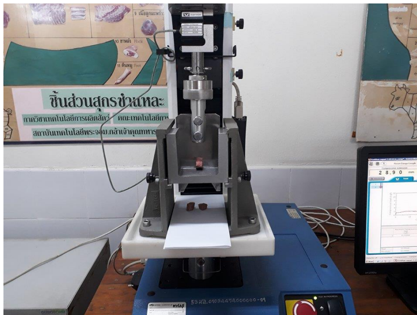
ภาพที่ 23 ภาพแสดงเครื่องวิเคราะห์แรงตัดผ่านเนื้อเพื่อหาความนุ่มของเนื้อ ที่มา : เอกอนงค์ สิทธิประการ ถ่ายเมื่อวันที่ 24 เมษายน 2561
