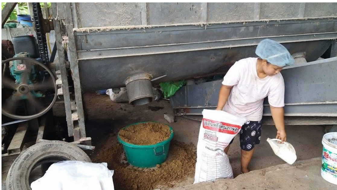
ภาพที่ 16 ลักษณะการนำอาหารที่ผสมเข้ากันออกจากเครื่องผสมอาหาร ที่มา : เอกอนงค์ สิทธิประการ ถ่ายเมื่อวันที่ 2 กุมภาพันธ์ 2560
