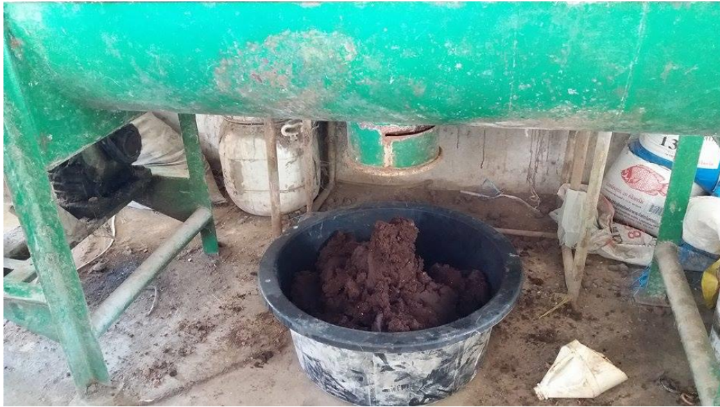
ภาพที่ 7 ลักษณะการนำอาหารที่ผสมเข้ากันออกจากเครื่องผสมอาหาร ที่มา : เอกอนงค์ สิทธิประการ ถ่ายเมื่อวันที่ 25 มกราคม 2560
