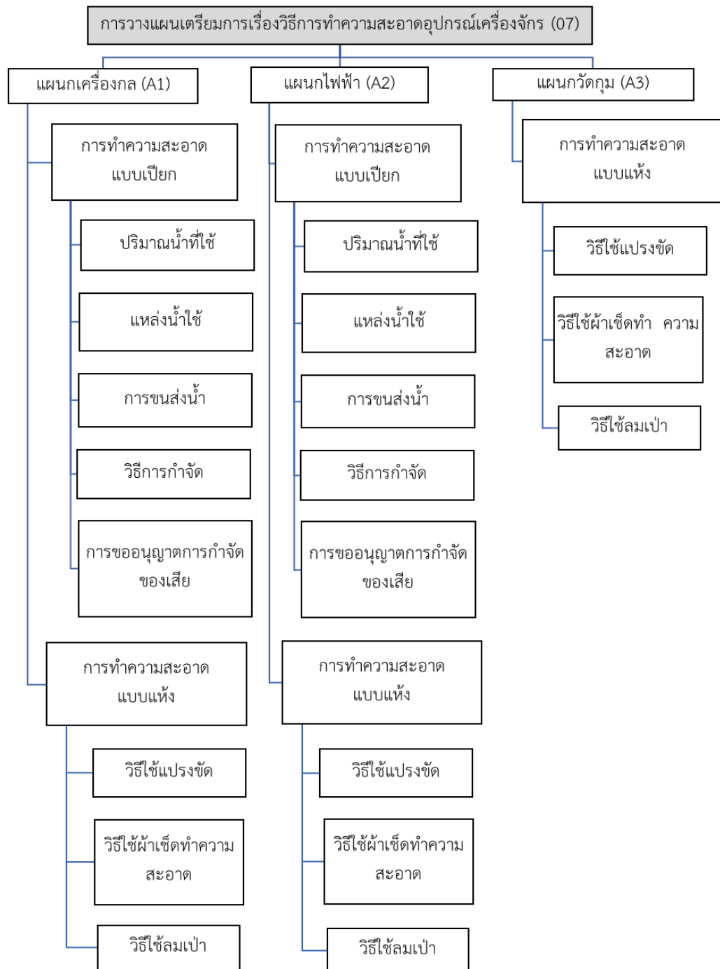
รูปที่ 4-20 การปรับปรุงโครงสร้างแผนงานการวางแผนเตรียมการเรื่องวิธีการทำความสะอาด อุปกรณ์เครื่องจักร
