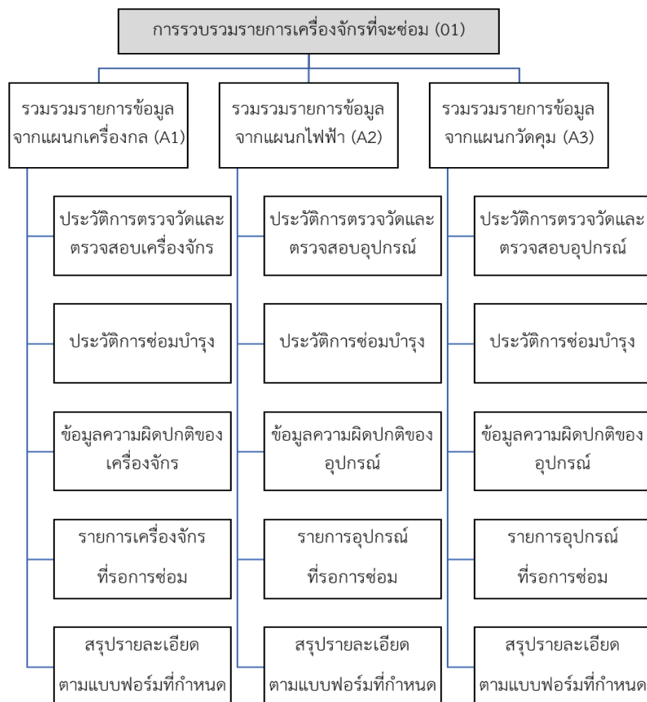
รูปที่ 4-14 การปรับปรุงโครงสร้างแผนงานการรวบรวมรายการเครื่องจักรที่จะซ่อม
