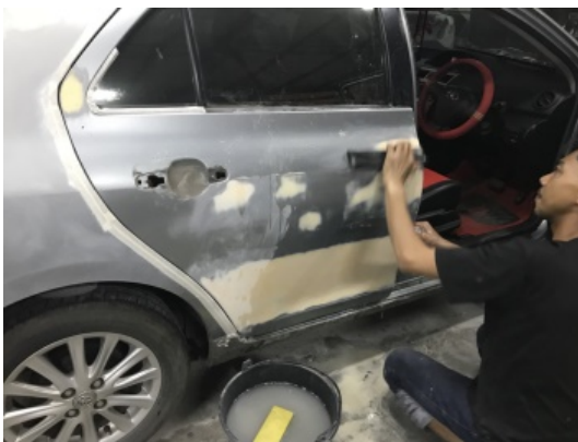
รูปภาพที่ 3. 25 การขัดสีโป้วด้วยกระดาษทรายแบบเก่า
