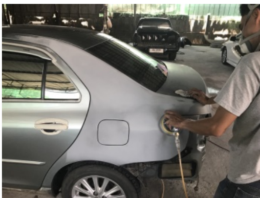
รูปภาพที่ 3. 26 ทดสอบการใช้เครื่องขัดกระดาษทรายกลมแบบใหม่
