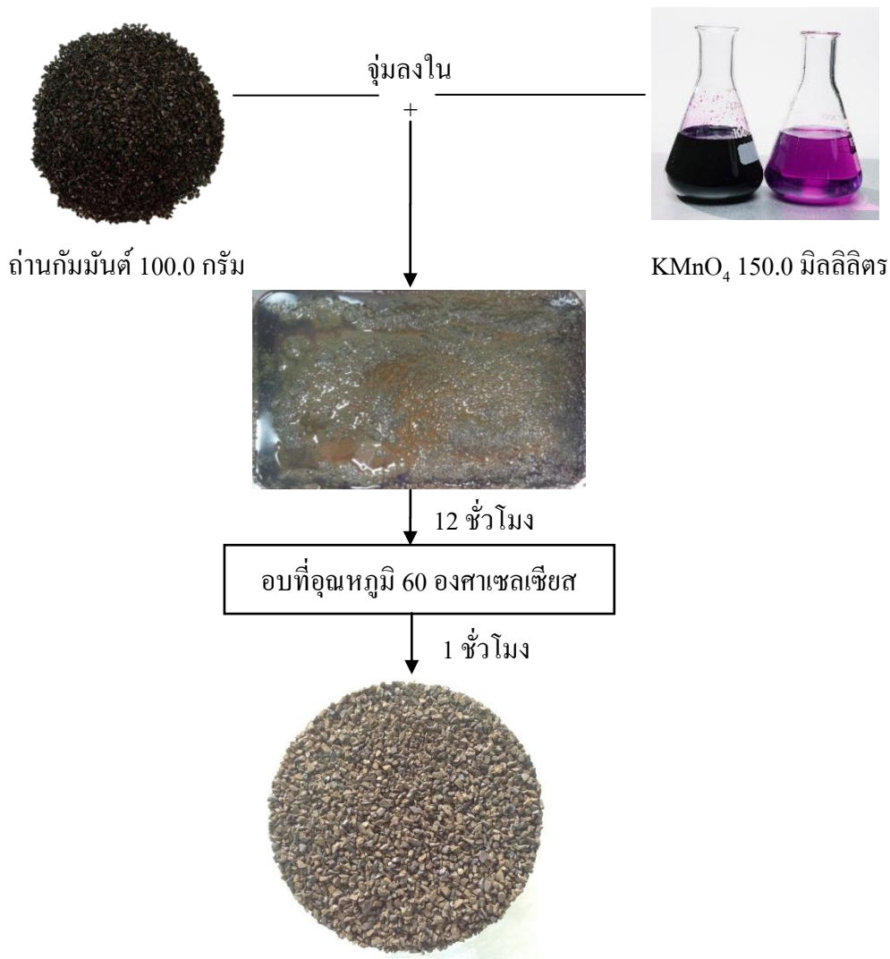
ภาพประกอบที่ 3-11 การเตรียมถ่านกัมมันต์เคลือบด้วยสารละลายโพแทสเซียมเปอร์แมงกาเนต
