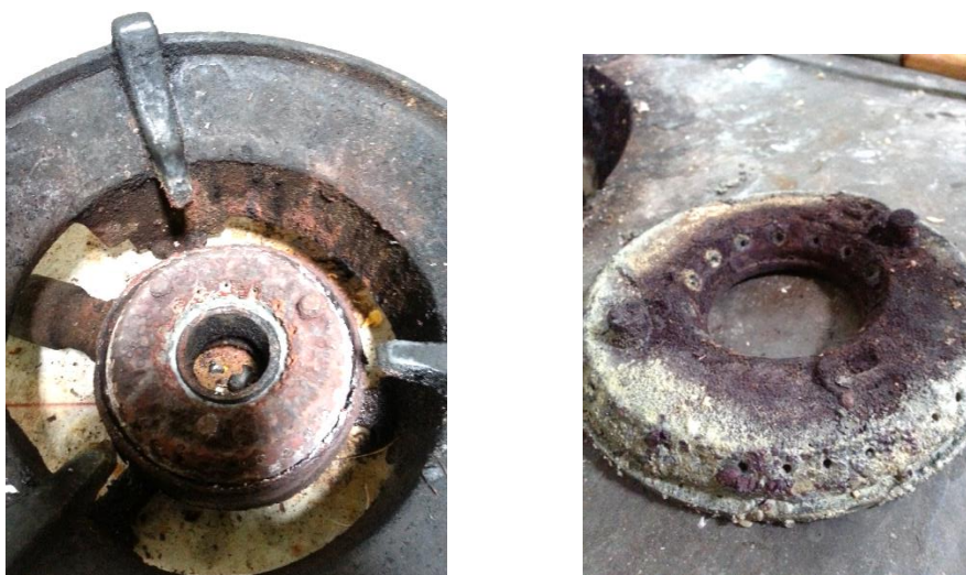
ภาพประกอบที่ 2-1 อุปกรณ์ที่ก๊าซไฮโดรเจนซัลไฟด์ในก๊าซชีวภาพกัดกร่อน
