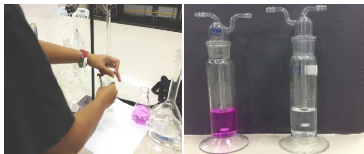
รูปที่ 3- 13 แสดงการวิเคราะห์ความเข้มข้นของอะซิติกด้วยวิธีการไทเทรต
