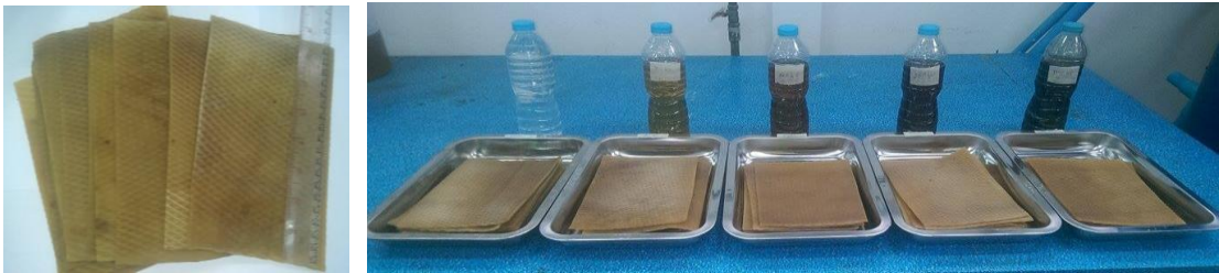
รูปที่ 3- 17 ยางเครพที่ผ่านการแช่น้ำส้มควันไม้เพื่อป้องกันเชื้อรา
