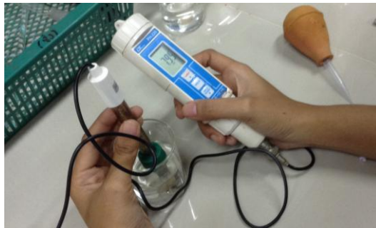
รูปที่ 3- 14 วัดค่าความเป็นกรด- ด่างตัวอย่างของเหลวที่เกิดขึ้นภายในถังหมัก
