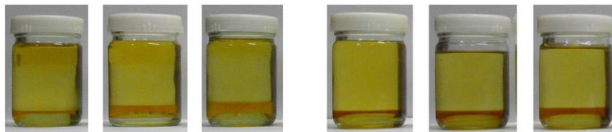
รูปที่ 4 การแยกชั้นระหว่างไบโอดีเซลกับกลีเซอรอล (45 vol.% MeOH) ที่ปริมาณตัวเร่งปฏิกิริยาเบสต่างๆ (ก) 7.8 gKOH.L -1 (86.548 wt.% ester), (ข) 12 gKOH.L -1 (97.968 wt.% ester) และ (ค) 16.2 gKOH.L -1 (95.750 wt.% ester) ที่ความยาว 1 เมตร ของ SM
