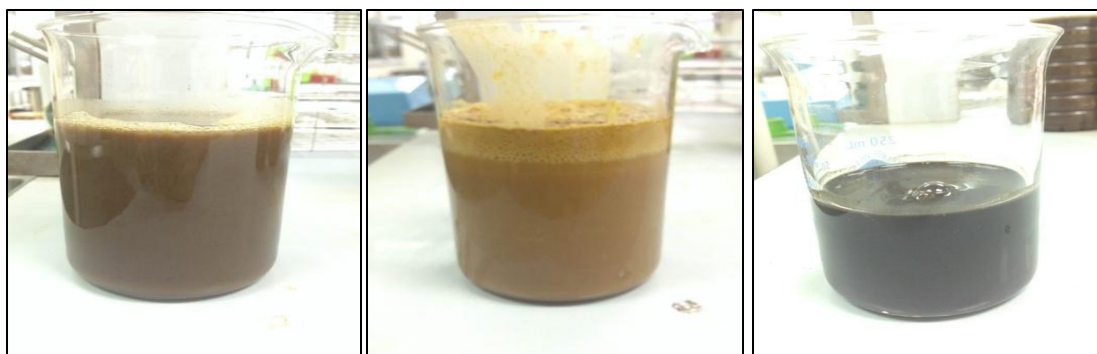
ภาพประกอบที่ 3-1 ลักษณะทางกายภาพของน้ำเสีย (A) น้ำเสียทั่วไปจากกระบวนการผลิตสกัดน้ำมันปาล์ม (B) น้ำเสียจากการบิณฑะลายเปล่าปาล์มน้ำมัน (C) กากตะกอนจุลินทรีย์
