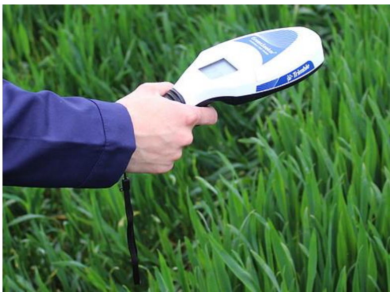
รูป 19 การใช้เครื่องมือวัดความสมบูรณ์/สภาพความแข็งแรงของพืชแบบอัตโนมัติ
