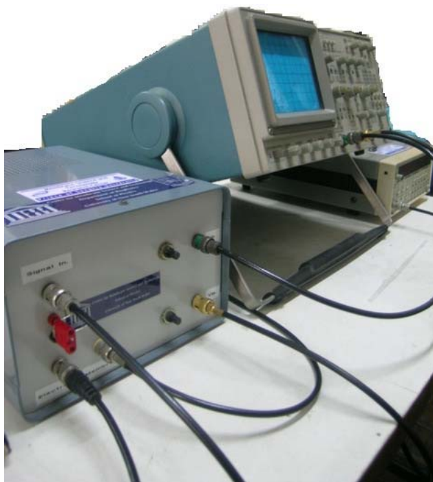
รูปที่ 3.7 อุปกรณ์การวัดค่าอิมพีแดนซ์ (Z) ที่ประกอบด้วย Differential Amplifier, Oscilloscope และ Function Generator
