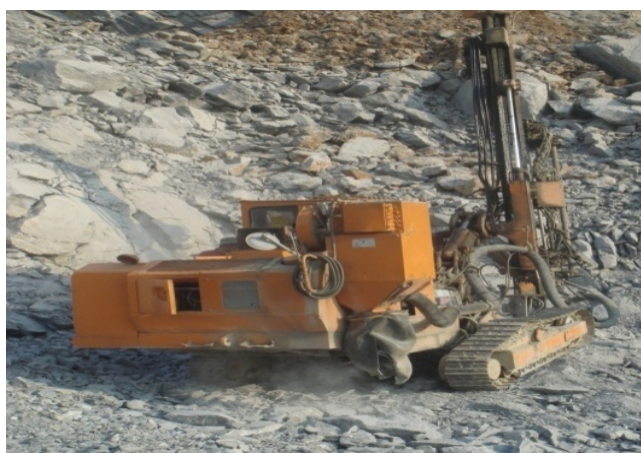
ภาพประกอบ 9 แสดงการเจาะรูระเบิดโดยใช้รถเจาะ
