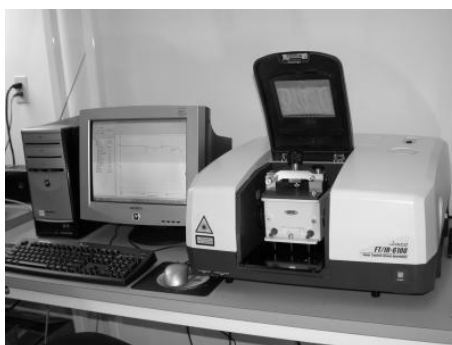
ภาพประกอบ 2-3 เครื่องอินฟราเรดสเปกโทรสโกปี [22]
