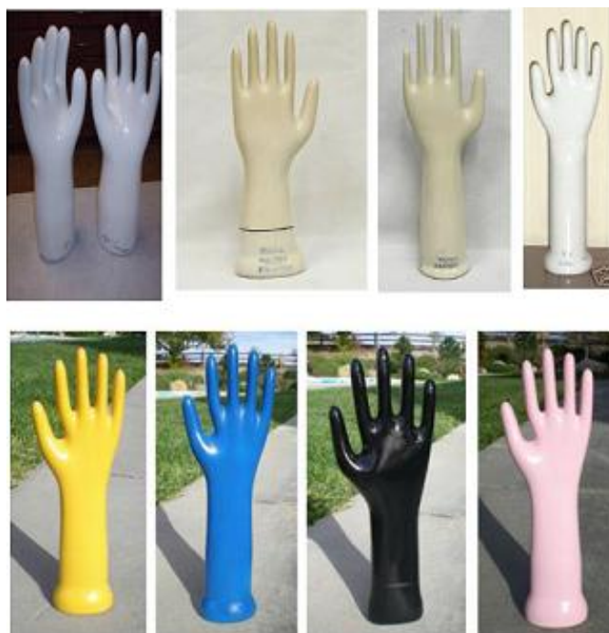
ภาพที่ 5 ตัวอย่างเป้าหมายเซรามิกสำหรับใช้ในการผลิตถุงมือยาง ที่มา : ทนงศักดิ์ วัฒนา และ ศุภชกรณ์ หลิมเฮงฮะ (2556)
