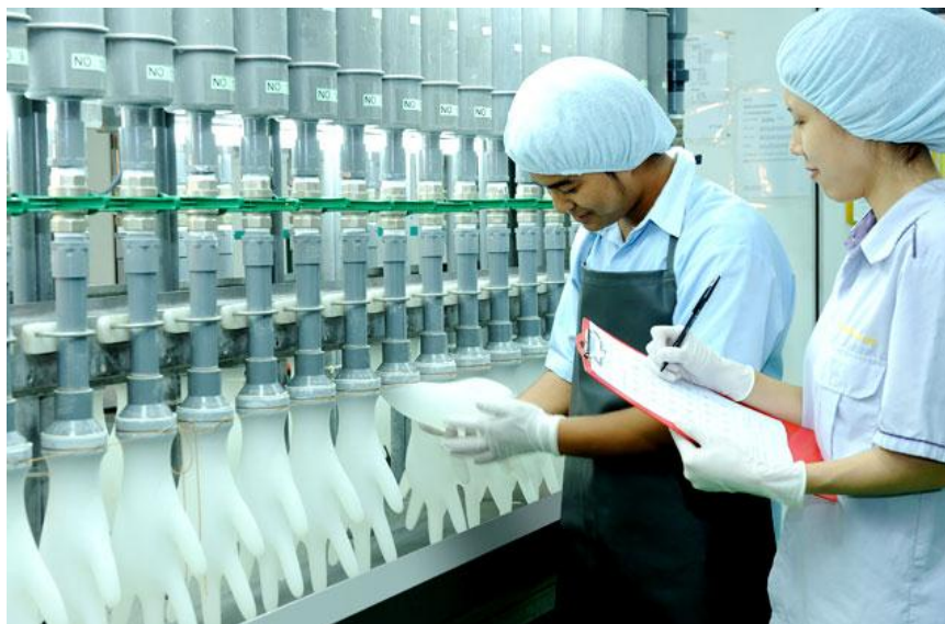
ภาพที่ 13 ตัวอย่างอุปกรณ์การทดสอบการรั่วซึมน้ำของถุงมือยาง ที่มา : Koon Seng (2014)
