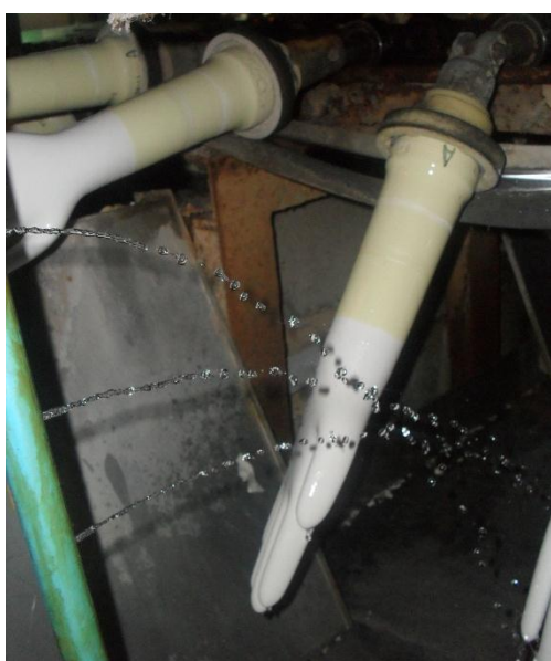
ภาพที่ 30 อุปกรณ์ชะล้างสารละลายกรดก่อนการปรับปรุง (ก) และหลังการปรับปรุง (ข)
