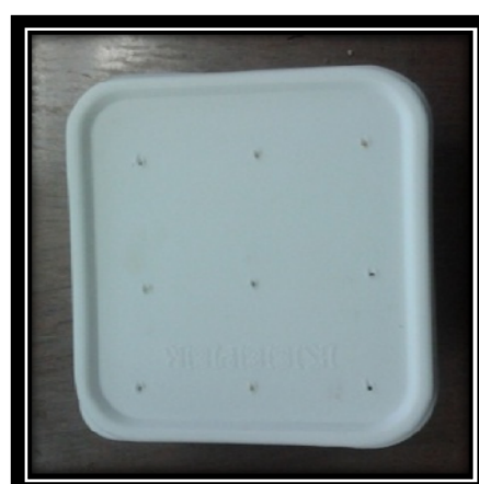
การเจาะรูที่ฝากล่องเพื่อระบายอากาศ (ข)
