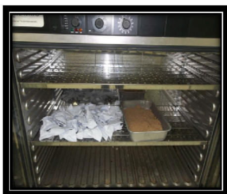
อบแห้งที่อุณหภูมิ 70-80 องศาเซลเซียส (ค)
