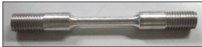
รูปที่ 2.22 ตัวอย่างทดสอบมาตรฐานของเหล็กหล่อตามมาตรฐาน ASTM E8
