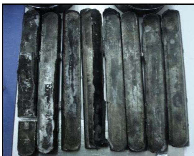
รูปที่ 2.9 ตัวอย่างชิ้นงานที่ผ่านการทุบขึ้นรูปแท่งกระบอกตันยาวในสถานะกึ่งของแข็ง
