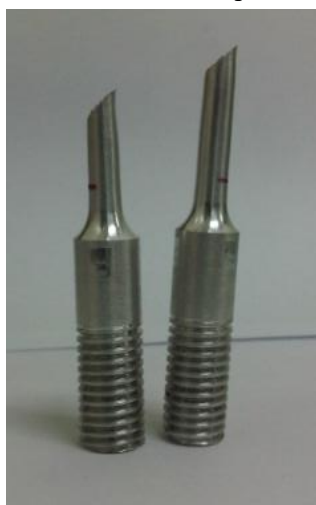
รูปที่3.47 การฉีกขาดของชิ้นงานเป็นมุม45° ตามการไถลของระนาบ (glide plane)
