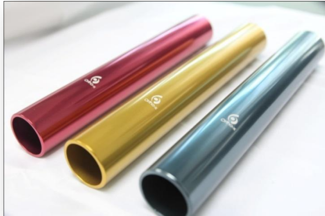
รูปที่ ผ.2 ท่อขาเทียมที่ผ่านการชุบผิวสีต่างๆ การจัดวางชิ้นงานเข้ากับเครื่องทดสอบ
