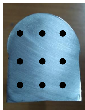
รูปที่ 2.20 เครื่องทดสอบความแข็งแบบ Rockwell Scale B และตำแหน่งที่นำไปวิเคราะห์ความแข็งของชิ้นงาน
