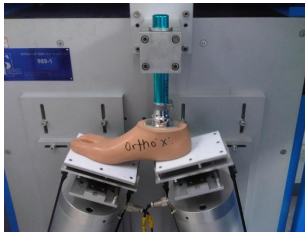
รูปที่ ผ.3 การจัดวางชิ้นงานเข้ากับเครื่องทดสอบ
