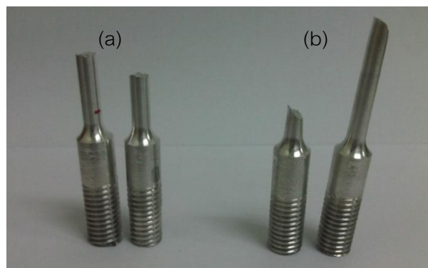
รูปที่3.41 ลักษณะการวิบัติแบบเปราะ (a) และการวิบัติแบบเหนียว (b)
