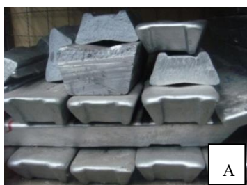
รูปที่ 2.1 ตัวอย่างอินกอตของอะลูมิเนียมผสมเกรด 7075 ที่ใช้ในการวิจัยขึ้นรูปแท่งกระบอกตันยาว (A) งานวิจัยการขึ้นรูปชิ้นงานแผ่น (B)
