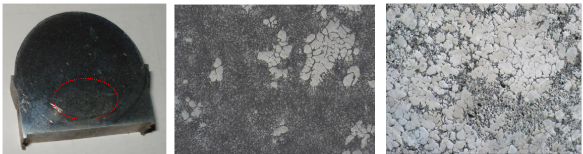
รูปที่ 3.18 แอ่งยูเทคติก (a) โครงสร้างจุลภาคตำแหน่งแอ่งยูเทคติกก่อนทำ T6 (b) โครงสร้างจุลภาคตำแหน่งแอ่งยูเทคติกหลังทำ T6 (b)
