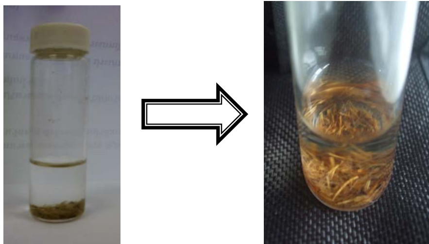
รูปที่ 2.5 ทดสอบการย่อยสลายฟีนอลของเซลล์ตรึงในขวดแก้วฝาเกลียวแล้วปมตัวอย่างที่ความเร็วรอบ 130 รอบต่อนาที ที่อุณหภูมิห้อง
