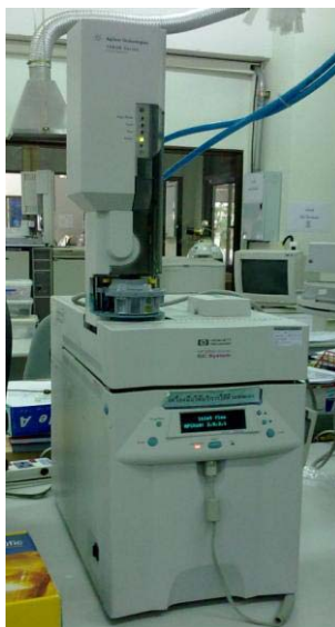
ภาพประกอบ 3-15 แสดงเครื่องแก๊สโครมาโตกราฟฟี (Gas chromatography, GC)
