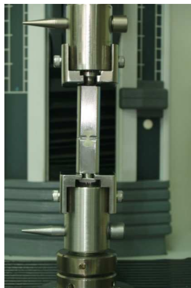
รูปที่ 19 ตัดชิ้นทดสอบมีรูปร่างเหมือนนาฬิกาทราย รูปที่ 20 เครื่องทดสอบแรงแบบอเนกประสงค์
