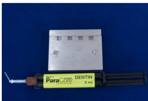
รูปที่ 12 วัสดุเรซินคอมโพสิตและแบบหล่อโลหะ
