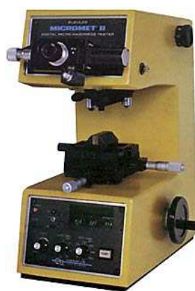
รูปที่ 9 เครื่องมือวัดและทดสอบความแข็งผิว (Microhardness tester, Micromet II; Buehler Ltd., Illinois, USA)
