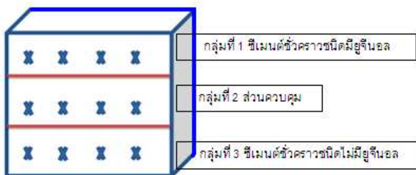
รูปที่ 10 ลักษณะรอยกดจากการทดสอบค่าความแข็งผิวแบบวิกเกอร์
