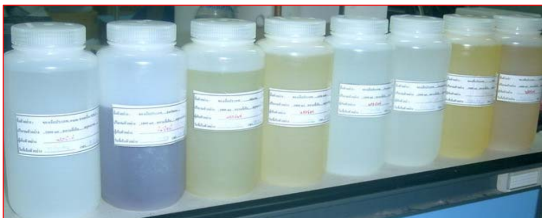
ภาพประกอบที่ 3 ลักษณะขวดพลาสติก HDPE ที่ใช้ในการสุ่มตัวอย่างของเสีย
