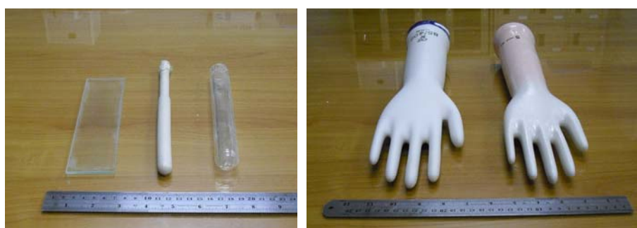
รูปที่ 2.3 แม่พิมพ์ที่ใช้ในการทดลอง ก) แม่พิมพ์หลอดแก้วและเซรามิกและแผ่นกระจก ข) แม่พิมพ์มือ
