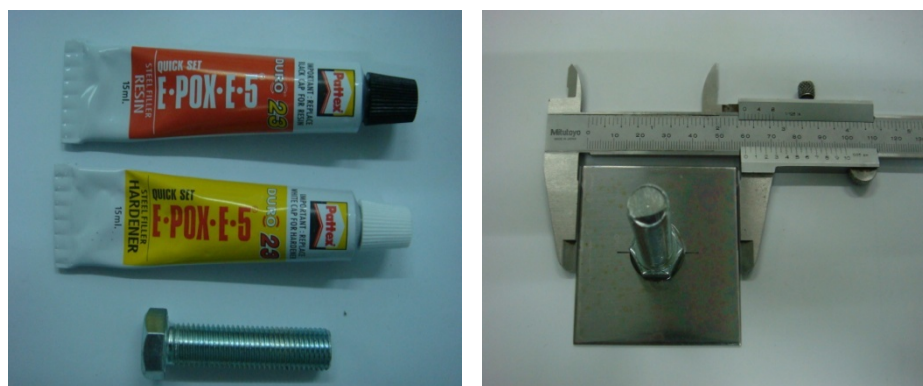
รูปที่ 3.38 กาวอีพอกซีและชิ้นงานที่ใช้ในการทดสอบความแข็งแรงของฟิล์มด้วยวิธีการดึง
