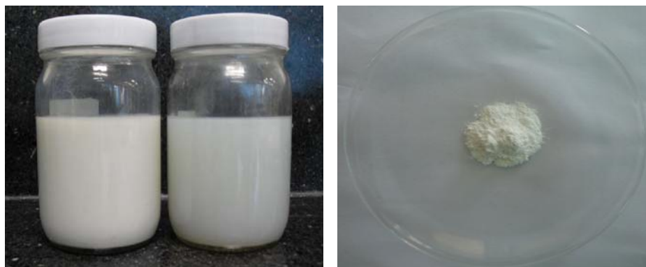
รูปที่ 3.3 โขลของไทเทเนียมไดออกไซด์และผงที่เผาที่อุณหภูมิ 100 องศาเซลเซียส
