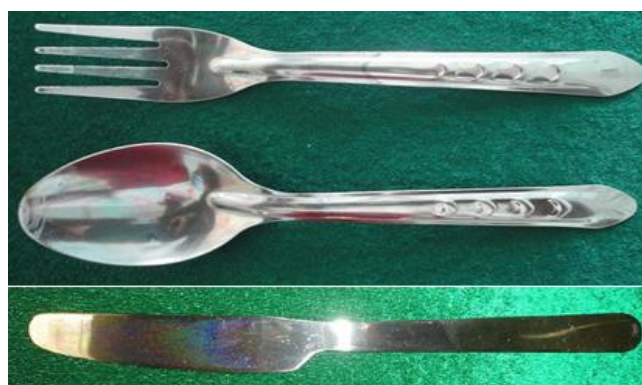
รูปที่ 3.41 ชิ้นงานที่ผ่านการเคลือบด้วยไทเทเนียมไดออกไซด์
