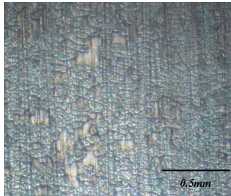
รูปที่ 3.13 ภาพถ่ายพื้นผิวของฟิล์มไทเทเนียมไดออกไซด์ที่จำนวนชั้นเคลือบ 7 ชั้น
