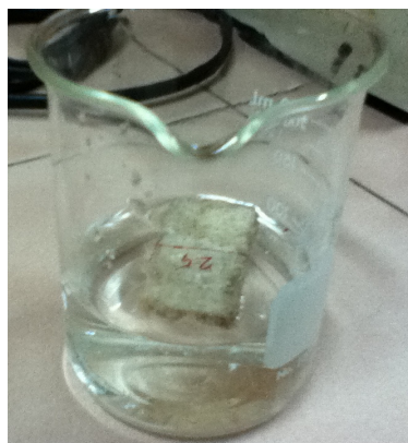
ภาพประกอบที่ 3.21 การทดสอบการดูดซับน้ำของชิ้นงานโฟมย่อยสลายได้
