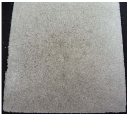
ภาพประกอบที่ 4.1 โฟมย่อยสลายได้ขึ้นรูปด้วยการอัดขึ้นรูปที่อุณหภูมิ 170°C ความดัน 2,000 psig เป็นเวลา 5 min
