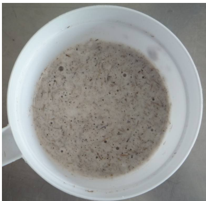
ภาพประกอบที่ 3.9 ของผสมที่มีการเติมเส้นใยปาล์มน้ำมันสำหรับใช้ในกระบวนการอัดขึ้นรูปเพื่อผลิตวัสดุโฟมย่อยสลายได้
