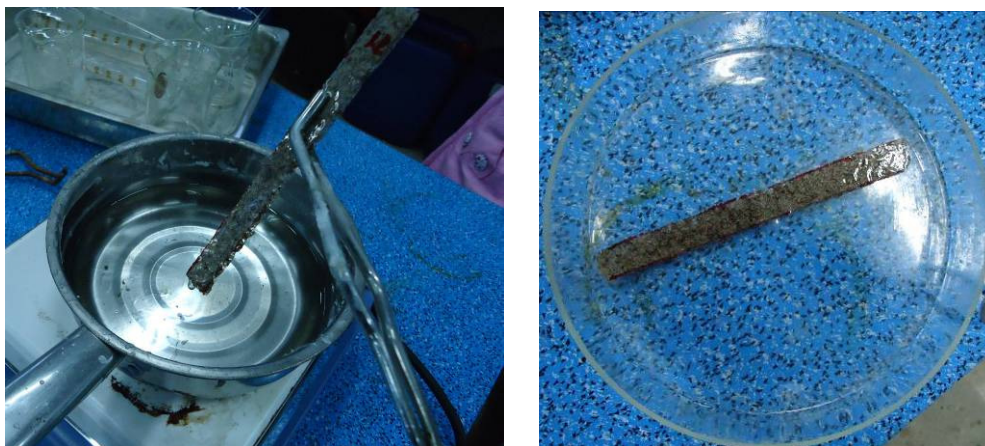
ภาพประกอบที่ 3.18 การเคลือบชิ้นงาน โฟมย่อยสลายได้ด้วยพาราฟิน แวกซ์
