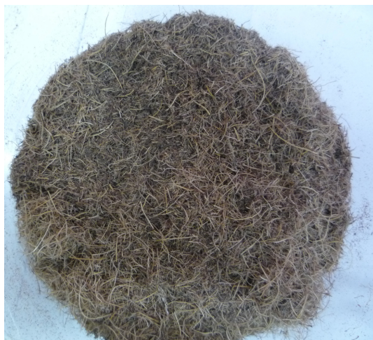
ภาพประกอบที่ 3.4 เส้นใยปาล์มน้ำมันที่ผ่านกระบวนการปั่นและแยกขนาดเส้นใย
