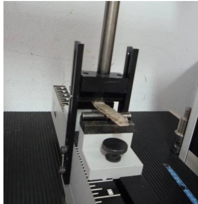
ภาพประกอบที่ 3.20 การทดสอบการตัดโค้งของชิ้นงานโฟมย่อยสลายได้
