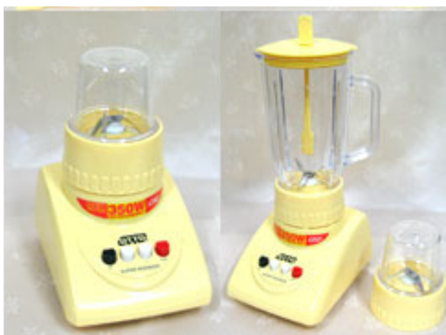
ภาพประกอบที่ 3.3 เครื่องปั่นสำหรับบดเส้นใยปาล์มน้ำมัน
