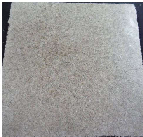
ภาพประกอบที่ 3.14 ชิ้นงานโฟมย่อยสลายได้ผสมเส้นใยปาล์มน้ำมัน
