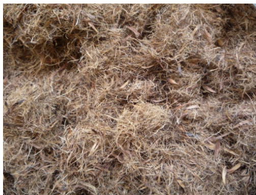
ภาพประกอบที่ 2.11 เส้นใยที่ได้จากเปลือกนอกของผลปาล์มน้ำมัน
