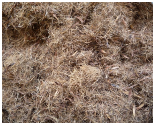
ภาพประกอบที่ 3.2 เส้นใยปาล์มน้ำมันที่ผ่านกระบวนการล้างและอบ
