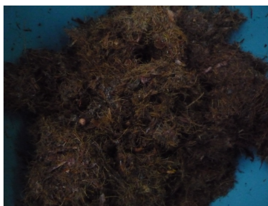
ภาพประกอบที่ 3.1 เส้นใยปาล์มน้ำมันที่ได้จากเปลือกนอกของผลปาล์มน้ำมัน
