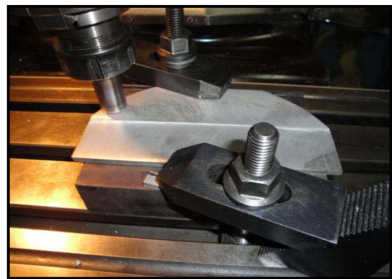
(ข) เริ่มเพิ่มแรงกดจนบ่าของตัวกวน สัมผัสผิวหน้าชิ้นงาน
