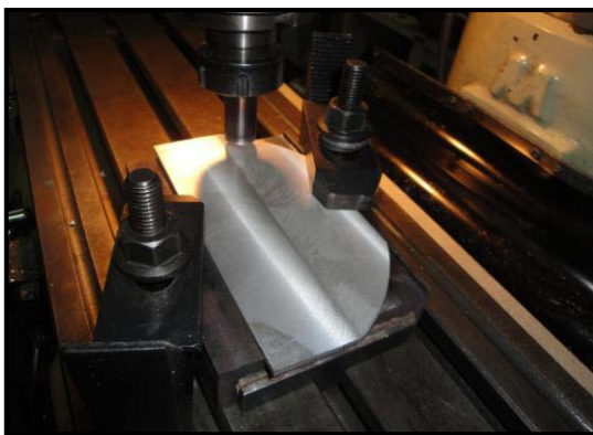
(ก) จับชิ้นทดสอบให้แน่นกับแท่นรองชิ้นงาน
