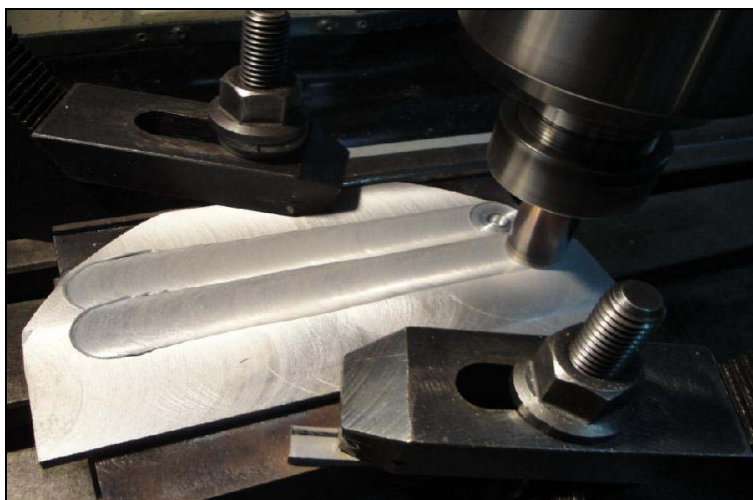
ภาพที่ 3.14 การจับยึดในกรรมวิธีเสียดทานแบบกวน
