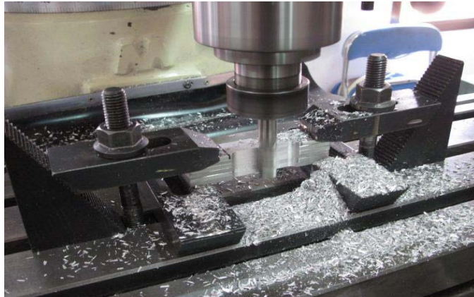
ภาพที่ 3.25 การขึ้นรูปชิ้นทดสอบแรงดึงของบริเวณรอยกวน
