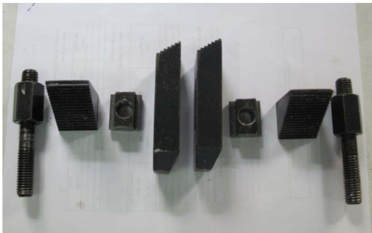
ภาพที่ 3.13 อุปกรณ์ที่ใช้ในกรรมวิธีเสียดทานแบบกวน
