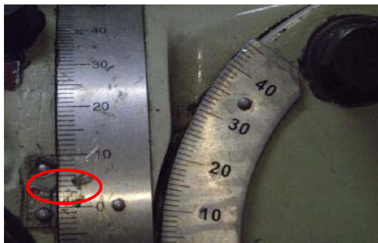
ภาพที่ 3.10 การปรับมุมเอียง 3 องศา ของเครื่องกัดแนวตั้ง
