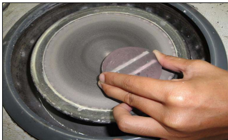
ภาพที่ 3.21 การเตรียมชิ้นงานเพื่อตรวจสอบ โครงสร้างทางโลหะวิทยา
