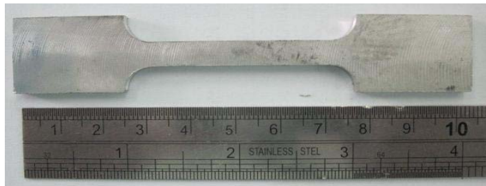
ภาพที่ 3.26 การเตรียมชิ้นทดสอบของรอยกวนเสียดทานแบบกวน
