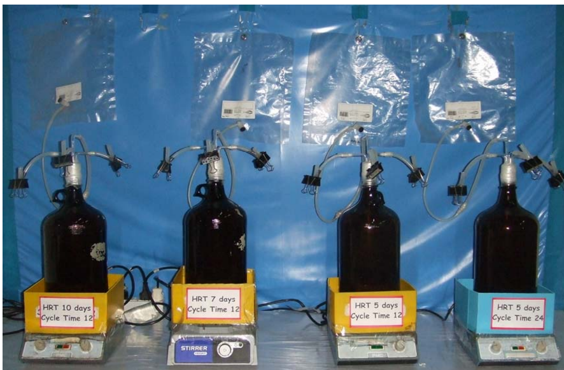
ภาพประกอบที่ 3-14 ลักษณะของระบบ ASBR ทั้ง 4 ระบบที่มี cycle time ที่เหมาะสมกับ HRT
