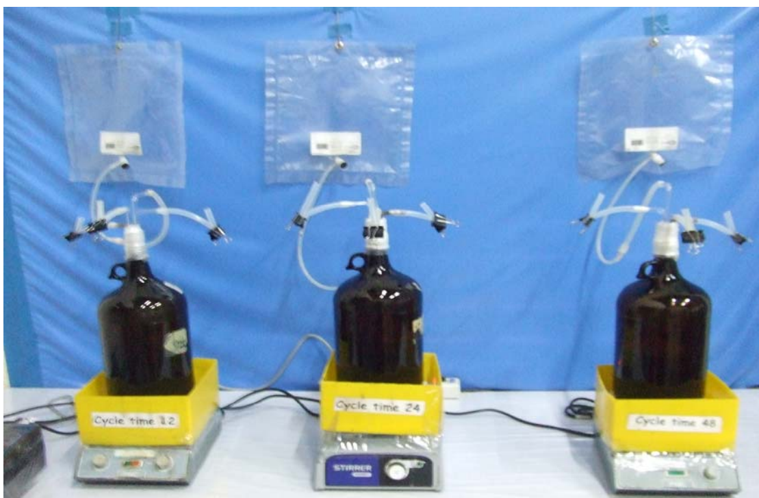
ภาพประกอบที่ 3-1 ลักษณะของระบบ ASBR ทั้ง 3 ระบบที่มี cycle time 12, 24 และ 48 ชั่วโมง
