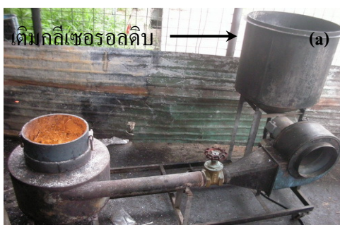
ภาพที่ 1-7 การใช้ประโยชน์ก๊าซเซอรอลดิบ (a) เตาก๊าซเซอริน (b) การใช้เตาก๊าซเซอรินในการดั่งกลับเมทานอลจากก๊าซเซอรอลดิบ
