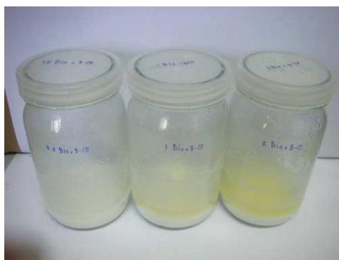
ภาพที่ 3-50 เจลที่มีผลึกสีขาวเป็นองค์ประกอบของสารประกอบเชิงซ้อนระหว่างไซโคลเด็กซ์ทรินชนิดเบต้ากับไบโอดีเซลบริสุทธิ์ที่เตรียมสารประกอบเชิงซ้อนด้วยวิธี dry mixing method
