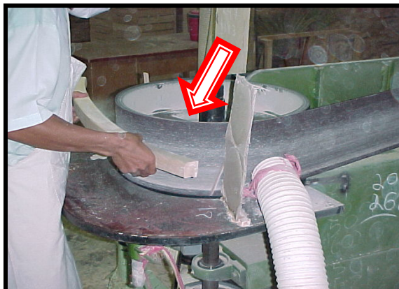
ภาพประกอบ 2.8 การขัดชิ้นงานด้วยเครื่องขัดสามเหลี่ยม
