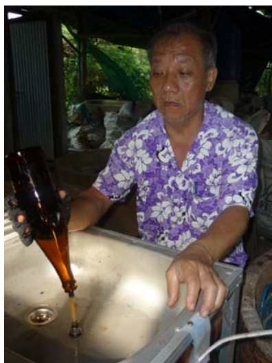
ภาพประกอบ 4.42 ผู้ปฏิบัติงานขยับขวดเพื่อให้แรงฉีดน้ำทำความสะอาดขวด
