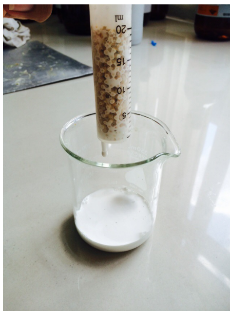
รูปที่ 3.10 การปล่อยน้ำยางไหลผ่านเม็ดเซรามิกเคลือบโคโตซาน
