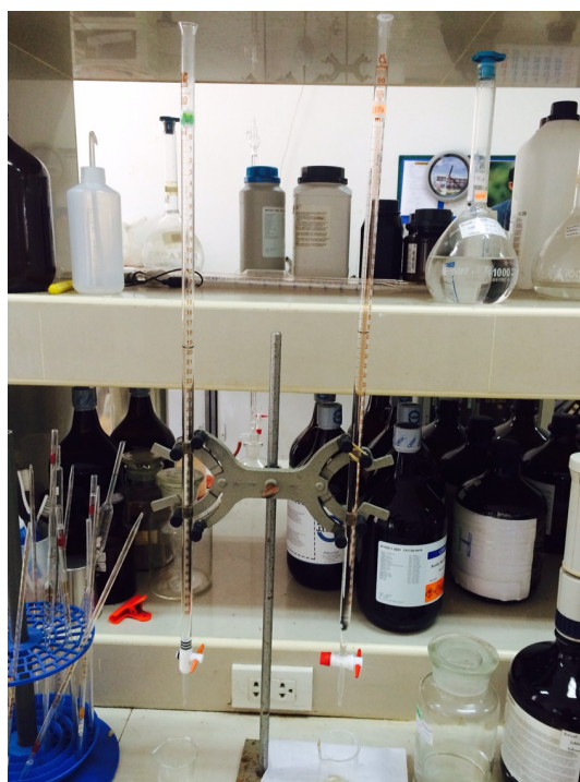
รูปที่ 3.12 เครื่องมือที่ใช้ในการไตเตรตหาปริมาณแมกนีเซียม
