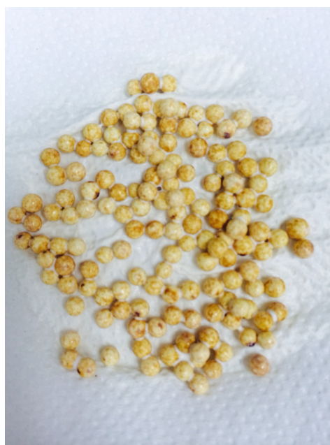
รูปที่ 3.11 ลักษณะเม็ดเซรามิกเคลือบโคโตซานหลังจากแช่น้ำยางธรรมชาติ
