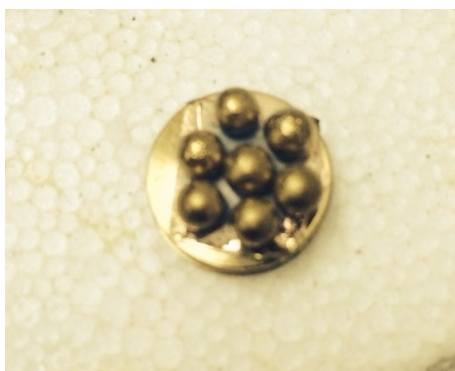
รูปที่ 3.13 ลักษณะเม็ดเซรามิกตัวอย่างที่เคลือบด้วยทองคำ
